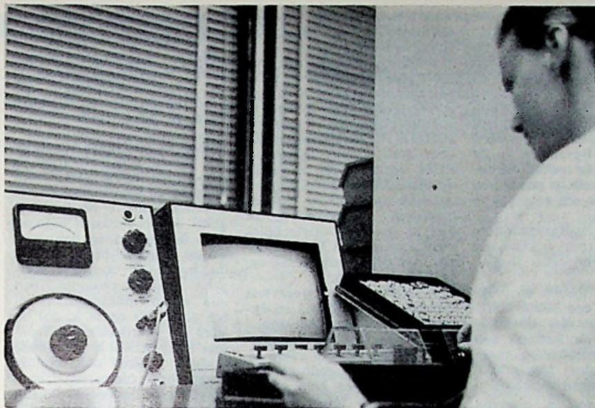
Afb. 4. Hier wordt op een TV-scherm de frequentiearakteristiek van het door ditzelfde meisje zojuist gemagnetiseerde kapsel gemeten. Duidelijk is het tolerantiegebied zichtbaar.
